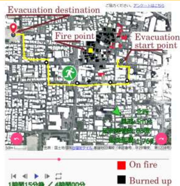
図2 延焼シミュレーションの結果例
