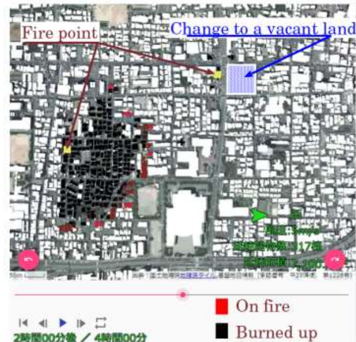
図4 空き地を活用(街並み設定)した火災に強い街作りシミュレーション例
