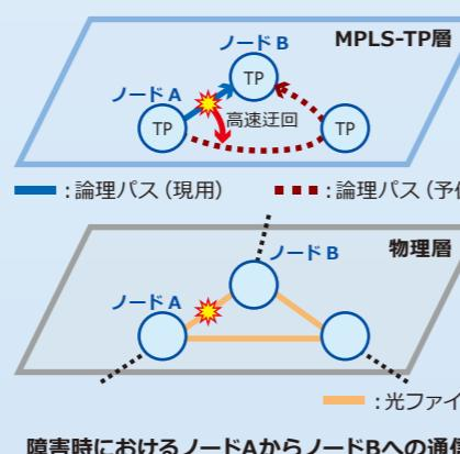
①各ノードは、必ず2本以上の異経路の光ファイバで接続されており、光ファイバ断線への耐障害性を高めています。
